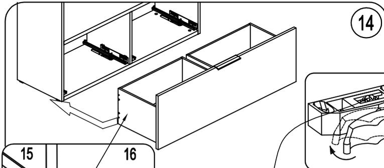
1. Прикрепить фиксатор Quadro к передней стенке ящика саморезом 3,5x16(1)
