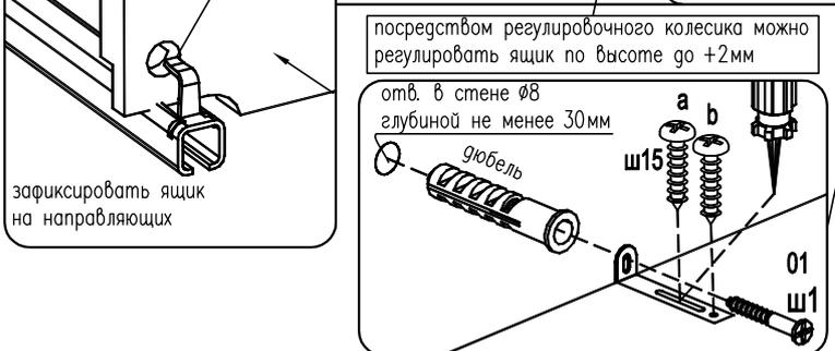
1. По угольнику разметить положение отверстия под дюбель в стене
